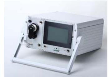
RPM 2200 является высокоточным и современным монитором дочерних продуктов распада радона и измерения эквивалентной равновесной объёмной активности (ЭРОА) радона/торона в воздухе.
